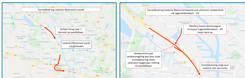
Figuur 9: Filevorming voor de tunnel
